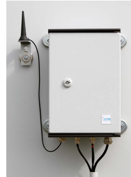
Bild 1: Fundamentmonitoringsystem. Die Steuerungsbox kann außen an der WEA in drei bis vier Metern Höhe installiert werden. Die Antenne kann in der Steuerungsbox oder außen angebracht werden.
